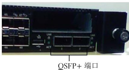
图 1. Dell Networking N4000 前面板
