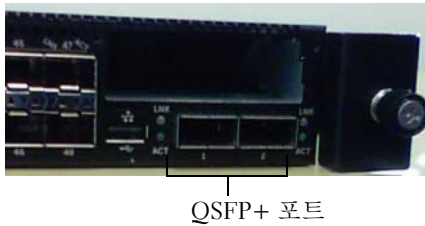
그림 1. Dell Networking N4000 전면 패널
